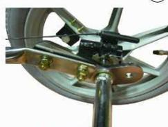
② センサー付きタイヤは、フレームに左写真のようなセンサーが取り付けられている側に取り付けます。タイヤの取付の際は、軸にナットが取り付けられておりますので、外してタイヤを取り付けて下さい。
