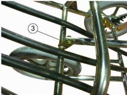
③ アームに取り付いているパイプを加工した部品の③のボルトとナットを外し、左写真の様に付ける。
