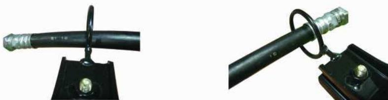
左右の長いホースはブーム噴管の左右に接続するホースです。配管セットの右側に取り付いているホースはブーム右側に、左側に取り付いているホースは左側に接続します。その時、ブーム噴管に取り付いているホース受けに通して接続して下さい。
