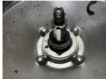
ポンプ空運転によるインペラと、メカニカルシールキット破損
