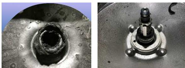
ポンプ空運転によるインペラとメカニカルシールキット破損
